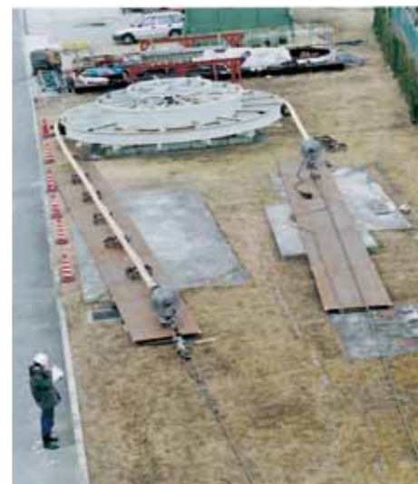
Tensile bending test (CIGRE test)
