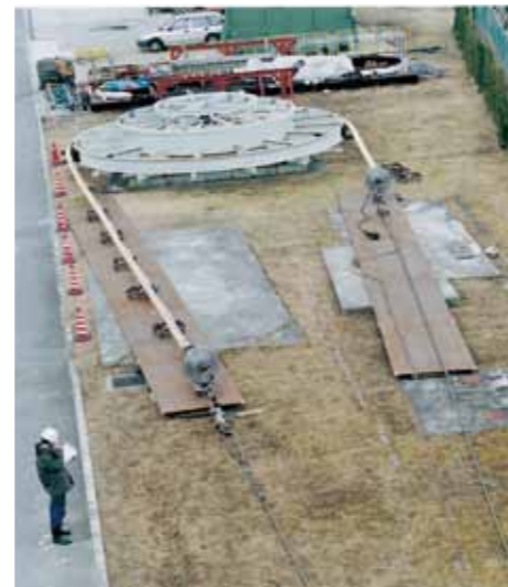
Tensile bending test (CIGRE test)
