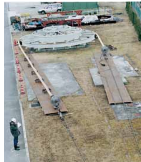
Tensile bending test (CIGRE test)
