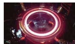
高周波焼入れの様子 Induction hardening
