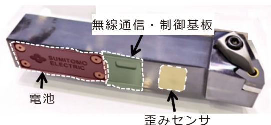
図1 現行の旋削加工用センシングツール
