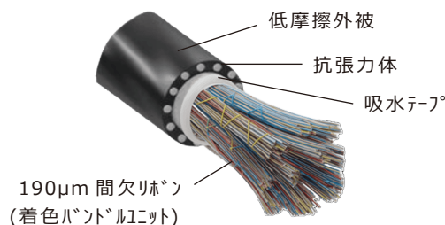
図3 864心マイクロダクト光ケーブルの模式図
