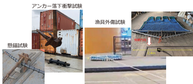
写真3 アンカー／底引き漁具によるケーブル外傷試験
