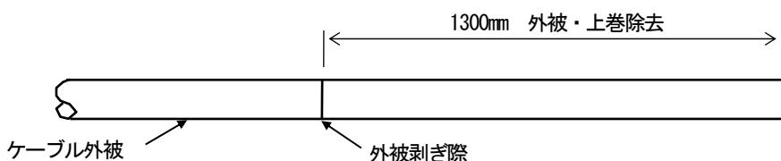
(2) 下図に示す寸法で、テンションメンバを剥ぎだしてください。
