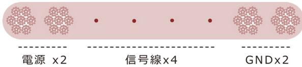
図3 UB-AOCにおける多芯集合構造
