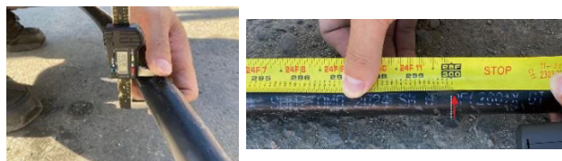
図10 牽引試験後の細径6912心O/Iケーブル寸法確認
