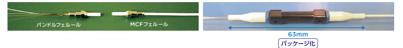
バンドル型 Fan-In/Out デバイス構造と外観
