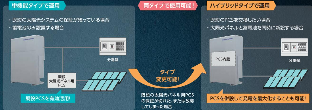
※併設設置する場合、既設PVは5.6kW以下の出力仕様の機器に限ります。
