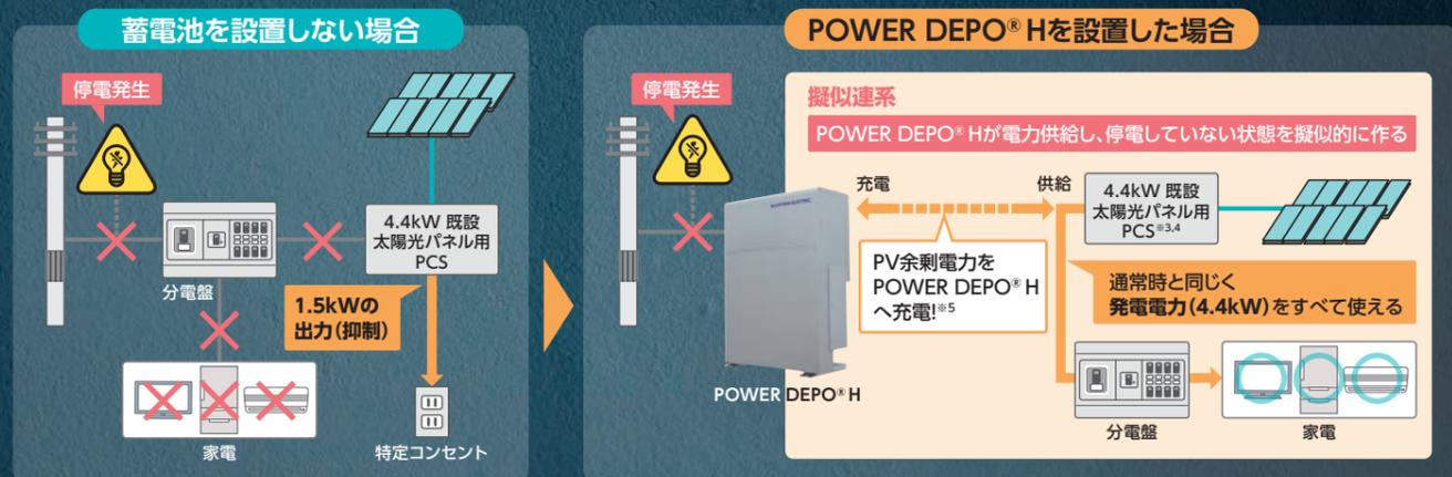
※1: 併設設置する場合、既設PVは5.6kW以下の出力仕様の機器に限ります。
