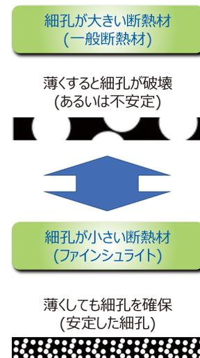
図4 断熱材の細孔による影響
