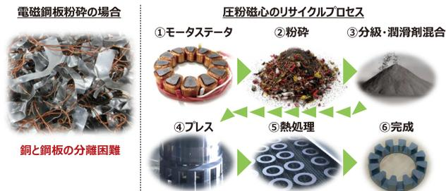
図5 検討した圧粉磁心のリサイクルプロセス
