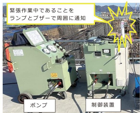
写真1 制御装置とポンプの外観
