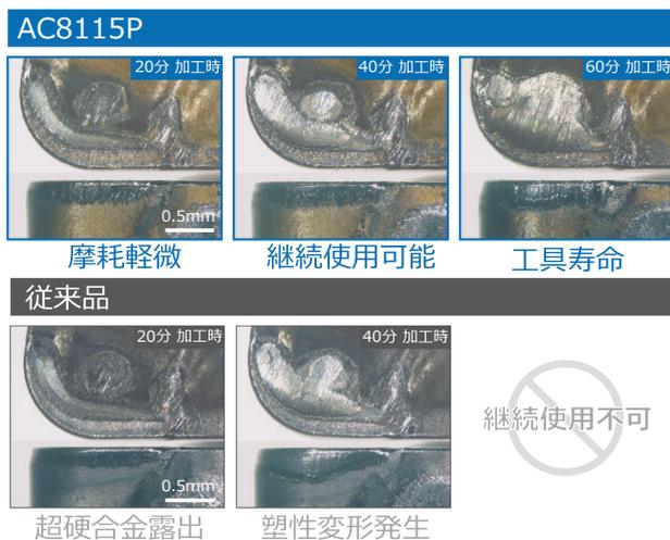
図5 AC8115Pと従来品の損傷状態比較
