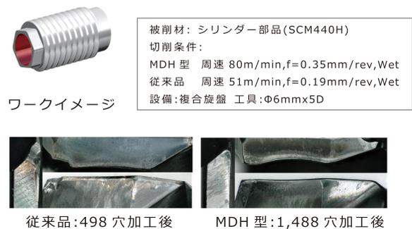
図16 MDH型によるSCM440H加工事例
