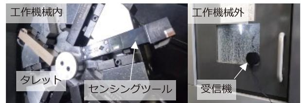
図3 実製造ラインでのセンシングツール設置
