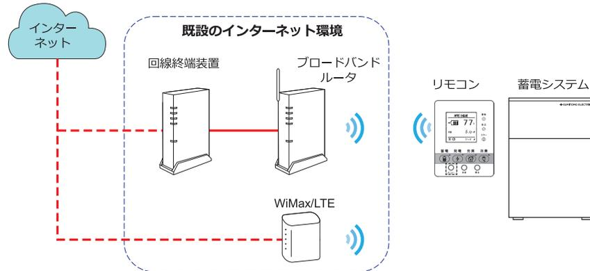
お使いの無線 LAN ルータが Wi-Fi Protected Setup™ (WPS) に対応している場合は「(2) WPS-PBC を使用する」、対応していない場合は「(3) 選択接続を使用する」をご確認ください。
