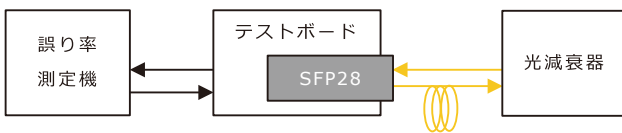
図8 受信特性の評価システム
