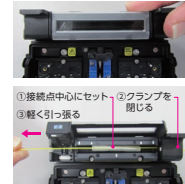
ファイバホルダ(真横から見た場合) 曲げ癖が残っている場合は 下向きにセット
