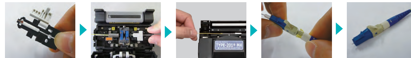
①スタブをホルダにセット ②融着 ③融着部を保護 ④ケブラを固定 固定が簡単になりました。 ⑤完成
