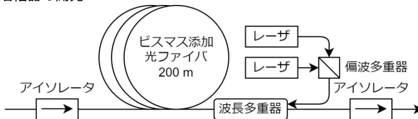
図 3 : 0 帯ビスマス添加光ファイバ増幅器 (BDFA) の構造
