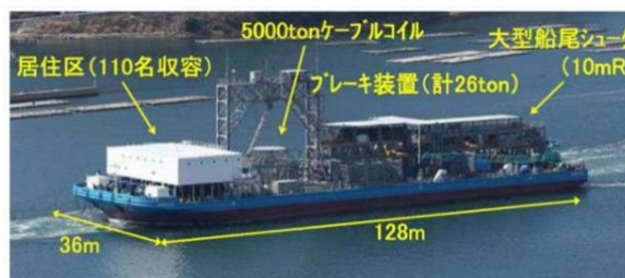
国内の中型布設台船の例 (大型自航式敷設船の開発予定)
