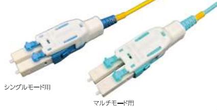
データセンタ内の超高密度配線にお使いいただけるユニバーサルLCコネクタ付2心ラウンドコードです。コネクタは治具を使わずに極性変換が可能で、従来品に比べ挿抜作業性を改善・進化(=progress)させました。コード部は業界トップクラスの細径1.6mmの中に光ファイバを2心内蔵、断面積は従来メガネコードのほぼ半分です。高密度配線時のコード輻輳を回避し、ラック内での配線作業の効率化に貢献いたします。
