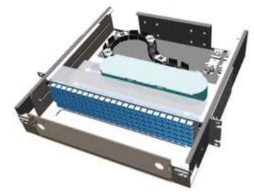
19インチラック用のスプライズユニットです。新たに採用した心線タイプの4芯FOプレ配線により、2Uで240心の高密度収容を可能にします。FOコード実装型のプレ配線は、現場での配線作業・点検作業時間を短縮し早期開通を実現します。キャップレスのシャッタ付LCアダプタを採用、さらに「プッシュプルグリップ方式」のFlexJLC® Proと組み合わせれば、コネクタ挿抜作業性もストレスフリーです。
