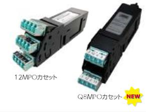
チルトアップ式LCアダプタを採用し、1Uで前面側最大144心の高密度実装と作業性の確保を両立したMPOカセットパネルです。MPOカセットは1段水平配列を採用し、増設・撤去時などの管理を容易にしています。MPOカセットを搭載するシャーシは19インチラック搭載型で、スライド式と固定式の2種類をご用意しております。QSFP+モジュールとSFP+モジュールの変換用として「Q8MPOカセット」を新たにメニュー化しました。
