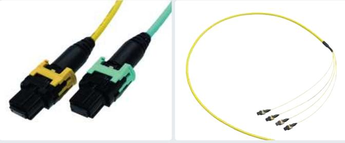
ネットワークラックとサーバラック間の大容量光配線を効率的に行えるのがSumiMPO®付トランクケーブルです。融着不要で12心など多心一括接続が可能な上、現地で容易に極性変換\*やガイドピン有り/無し変換ができる等、機能性も高めました。また、複数本のケーブルが積み重なる床下配線等にもお使いいただけるよう、ケーブルに二重シースを施すことで機械的強度を高めています。
