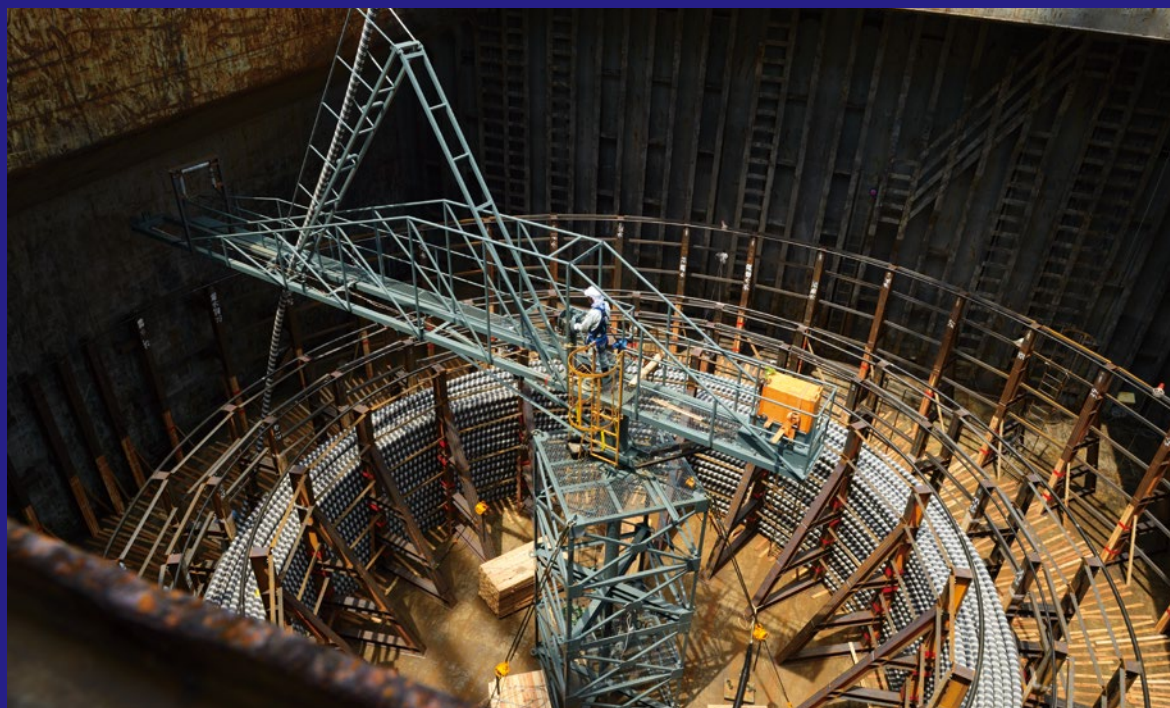
NEMOリンク向け船積みされる直流XLPEケーブル
