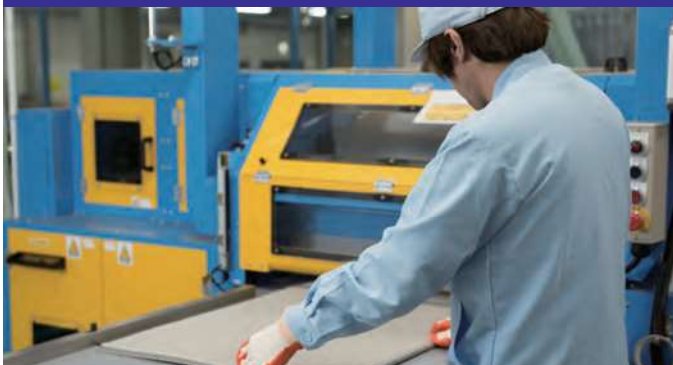
圧延ロールによる厚み調整
