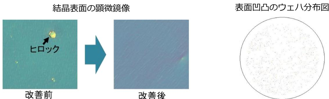
図2 N極性 GaN 結晶の高品質化
