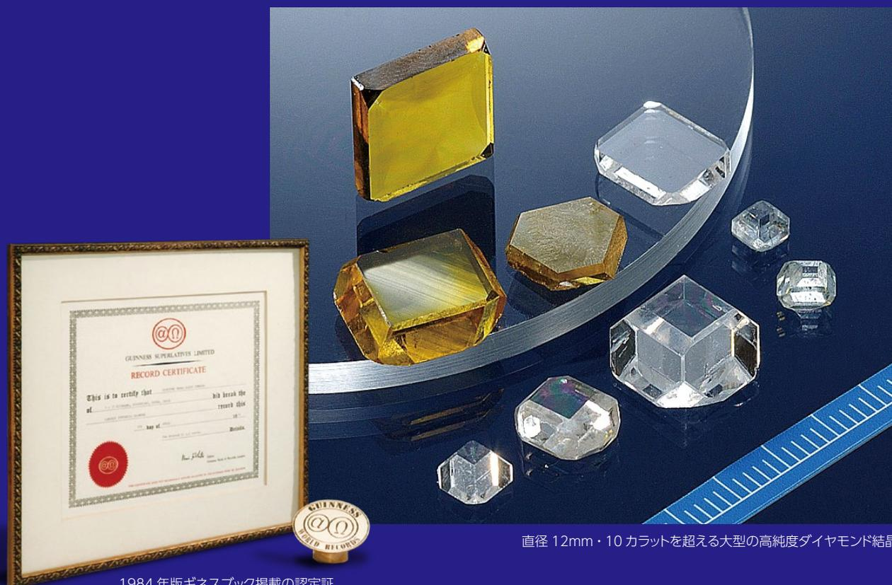
直径 12mm・10 カラットを超える大型の高純度ダイヤモンド結晶
