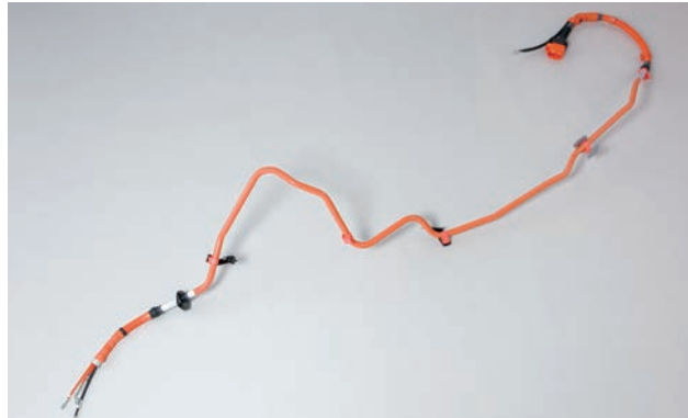
床下パイプハーネス
