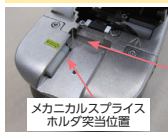
ロック爪段差有 メカニカルスプリング 対応タイプ (スペース不要)
