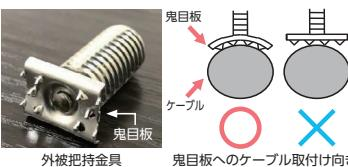
■テンションメンバ把持金具でテンションメンバを把持する際、テンションメンバの表面にスロット材料カスが残っていないことを確認してください。カスが付着していると把持力が低下し規定の把持力を満足しない場合がありますので、サンドクロスなどでカスを除去してください。テンションメンバ把持金具を締め付ける際は、テンションメンバが把持部V溝に嵌っている事を確認してください。テンションメンバ把持金具の締付トルクは、各クロージャの工法書を参照してください。
