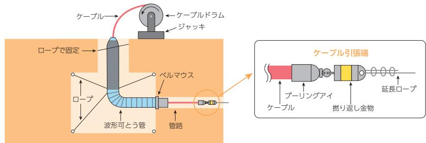
■光ケーブルの先端にブーリングアイ等の引っ張り端末を取り付けます。
