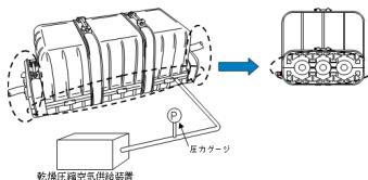
気密が確保されているか確認するために、施工後にガスフラッシュテストの実施をお願いしています。光クロージャのガスバルブからガスを供給（乾燥圧縮空気供給装置などを使用）しながら点検液（石鹼水等）を用いて目視で確認します。
