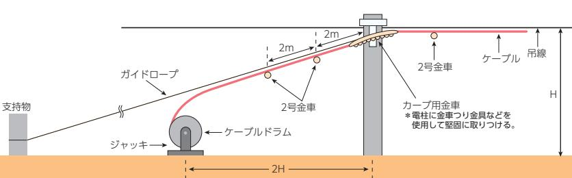
■敷設時は、光ケーブルに捻回が発生しないように、擦り返し金物・捻回防止器などを使用します。
