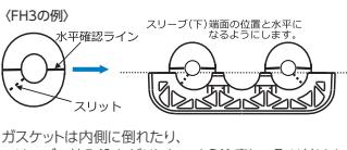
ガスケットは内側に倒れたり、スリープで挟み込んだりしないよう注意して取り付けます。
