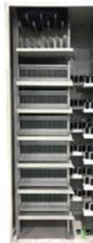
外部とデータセンター内の光ケーブルをMDF室で接続するのが大型光成端架です。SODF-56型光成端架は、1架で最大2000心の収容が可能な高密度型で、データセンターの多芯ニーズにお応えします。スライド式8芯分岐モジュールが高密度化と良好なコネクタ挿抜性を両立させ、独自のUターン配線によるコードマネジメントにより2000心分の心線識別を容易にし、現場の線番管理をサポートします。
