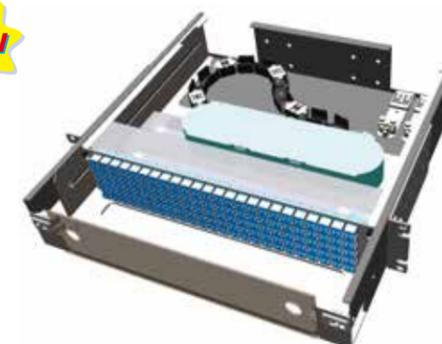
19インチラック用のスライスユニットです。新たに採用した心線タイプの4芯FOプレ配線により、2Uで240心の高密度収容を可能にします。FOコード実装型のプレ配線は、現場での配線作業・点検作業時間を短縮し早期開通を実現します。キャップレスのシャッタ付LCアダプタを採用、さらに「プッシュプルグリップ方式」のFlexULC® Proと組み合わせれば、コネクタ挿抜作業性もストレスフリーです。
