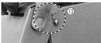
2. ヒートシンクカバー取り付けたあと、下ネジ(⑭)をドライバで固定する。
