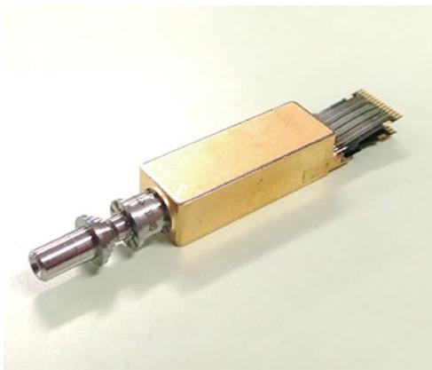
写真1 4ch集積光受信モジュール
