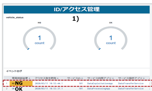
図 13 システムが車両で不正アクセスが起きていることを検知する (図中破線部)。管理者は当該箇所をクリックし詳細を表示する。
