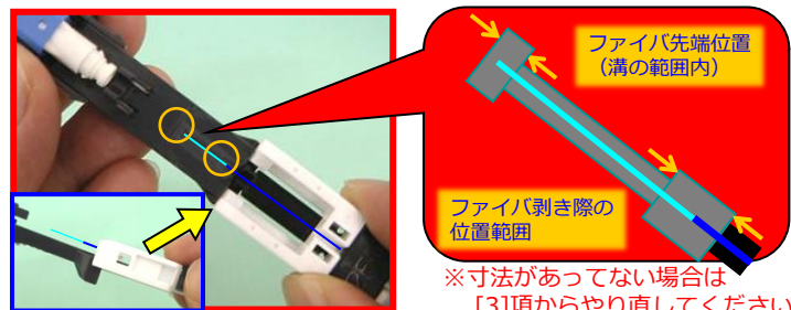
【8】カット寸法確認 (治具のゲージで必ず確認ください!)
