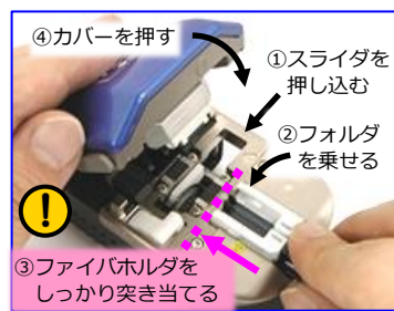
【7】ファイバカット (※当社製FC-8R-MC使用の場合)
