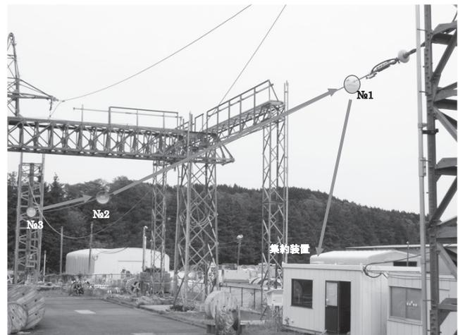
写真6 課電状態での情報収集端末動作試験
