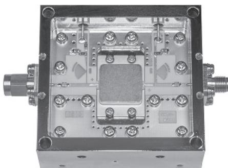
図8 X帯 200 W評価治具
