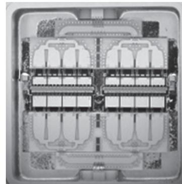
図5 X帯200 W 内部回路
