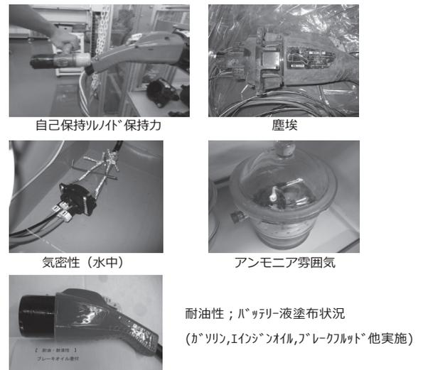
写真8 V2X用コネクタ 社内評価試験（抜粋）
