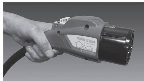
写真6 V2X用コネクタ: SEVD-V1, SEVD-V2
