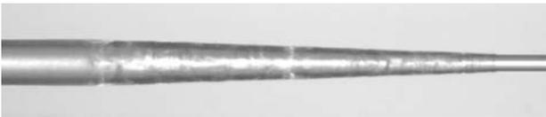
写真1 エッチングされた細径光ファイバ
