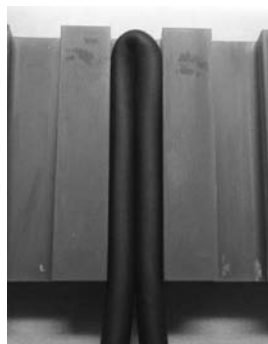
写真2 ケーブル折り曲げ試験
