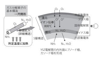
図2 ガス分解素子の基本構造
