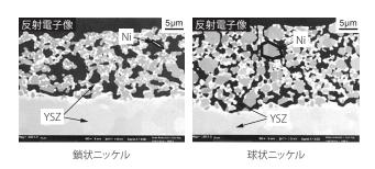
図5 アノード触媒層の断面観察
