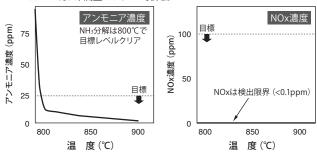
出口濃度でアンモニア除害を確認。NOxは発生せず
