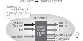
図1 ガス分解素子を用いたガス分解の概念図
