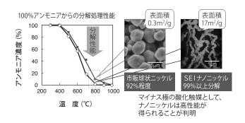
図4 アノード触媒性能の比較評価
