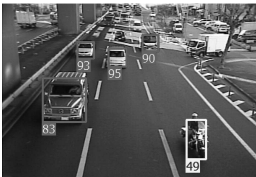
図8 検出と追跡の組み合わせ実験の結果の一例 各車両の左下の数字は、追跡対象に固有のID番号
