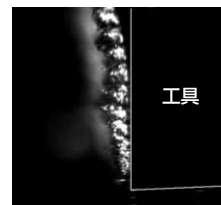
図11 工具離脱時の切りくず付着 (Vc = 80m/min)
