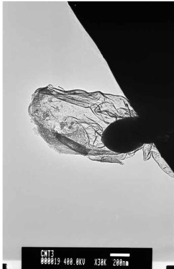
図8 炭素透過側の鉄ナノフィラメント先端から生成するCNTのTEM写真
