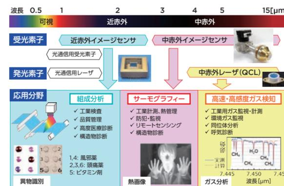
光通信用受光素子の要素技術を応用して、量子井戸型の赤外線イメージセンサの開発を行っています。従来のセンサと比較して高感度で、微量分析や微小な温度差を画像で検知する診断システムに適しています。
