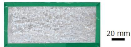
写真1 Fe量139ppm、Al量0.19wt%を含むMg合金の96時間塩水噴霧試験後外観
