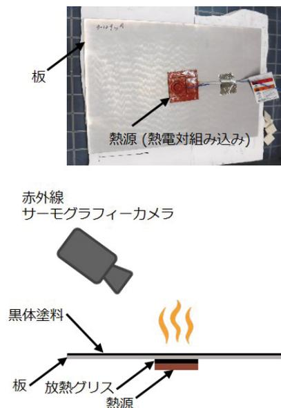
図2 電子機器用の筐体を模擬した放熱性評価試験概要図
