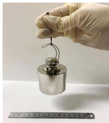
写真3 \phi 0.4\text{mm} で1kgを持ち上げ可能
