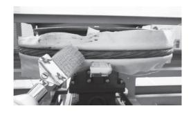
写真3 曲げ試験時のピンホール検査(ECF型)
